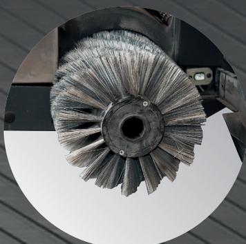
Regolazione della velocità, clacson, regolazione pressione spazzola centrale, regolazione automatica altezza squeegee. Sistema di dosaggio del detergente. Raggio di sterzata ridottissimo. Robusta e grande spazzola centrale d.300 autolivellante, a pressione regolabile e a rotazione anti-oraria.
