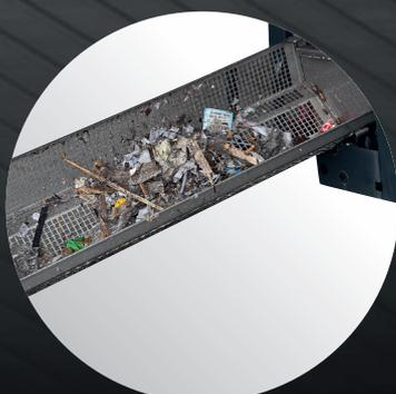
Robusto sistema squeegee in acciaio. Perfetta asciugatura anche nelle curve più strette. Serbatoio recupero detriti ampio e facile da estrarre. Fino a 30 litri di raccolta sul modello 85.
