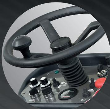
Pannello di controllo con comandi facile e intuitivo dotato di: contatore, indicatore del livello di carica della batteria, spia del serbatoio vuoto e indicatore di trazione in avanti/indietro.
